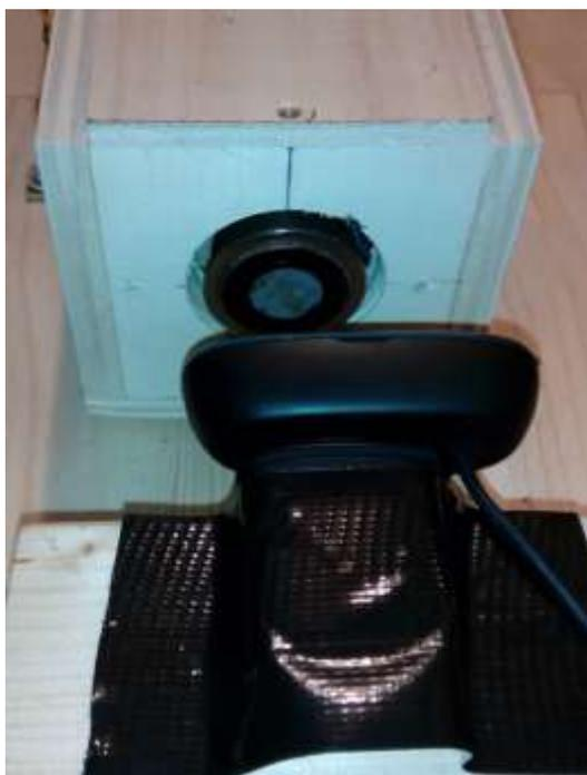
Abbiamo utilizzato il sensore a Webcam per fare una prova con un generatore di **raggi X a 15kV**. Nella figura a lato si vede il dettaglio della Webcam posizionata di fronte alla finestra anteriore (in berillio) del tubo. La Webcam è sensibile, anche se con bassa efficienza, ai raggi X. Sotto si vede il dettaglio di alcuni pixel attivati da fotoni X. La luminosità dei pixel è bassa a causa della bassa energia dei fotoni X.
