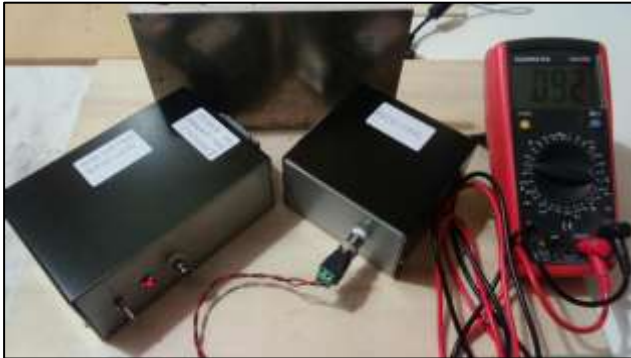
Setup per la verifica della riflessione delle microonde da una superficie metallica
