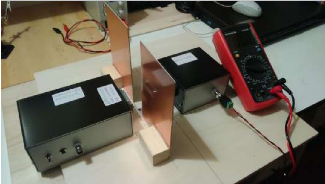
Setup per la verifica della diffrazione da una fessura
