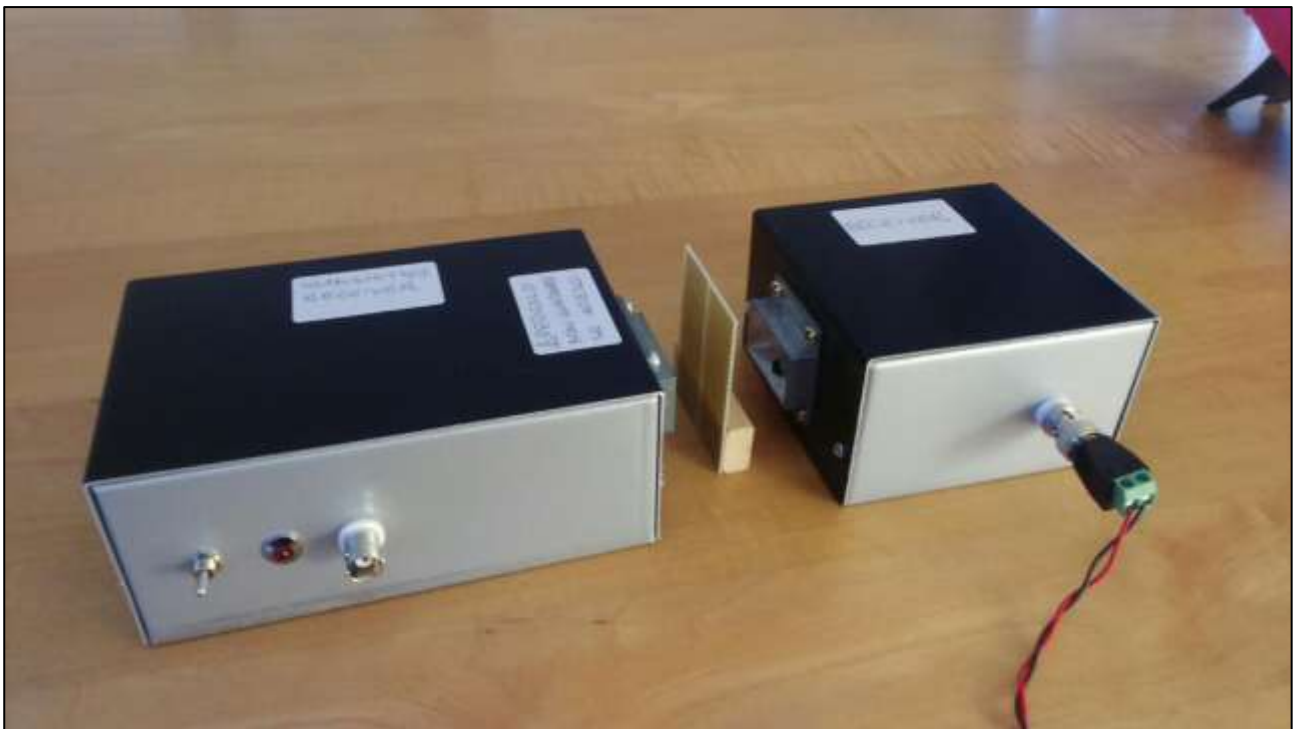
Setup per le misure di polarizzazione del fascio con filtro polarizzatore
