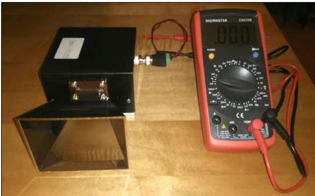
Nella figura sopra si vede il Receiver con la guida d'onda frontale ed il connettore BNC per il segnale di output
