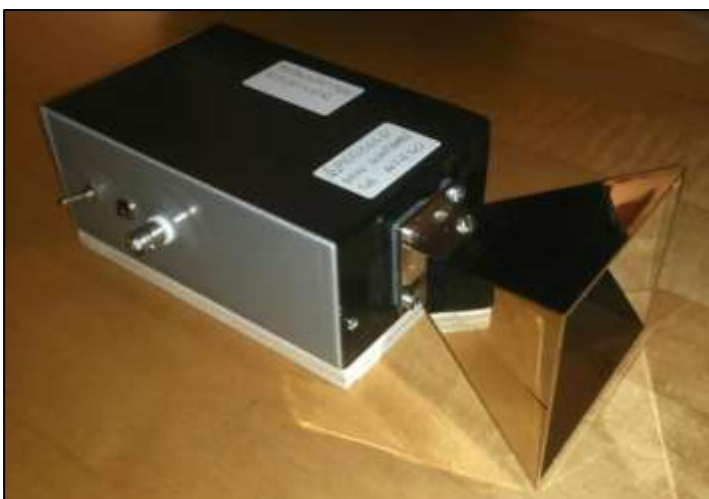
Schema del transceiver con alimentazione stabilizzata sul diodo Gunn e segnale di output prelevato sul diodo mixer
