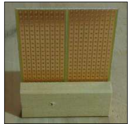
Schema di principio di un polarizzatore ed esempio di polarizzatore per microonde
