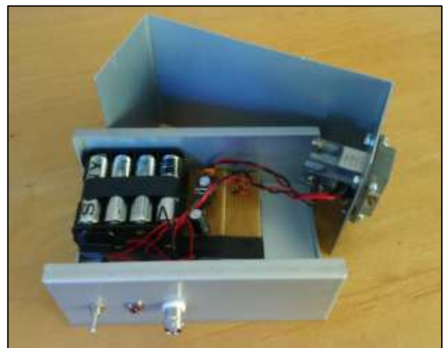
Schema del transceiver con alimentazione stabilizzata sul diodo Gunn e segnale di output prelevato sul diodo mixer
